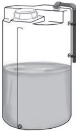
Typ Q Befüllleitung Standard
