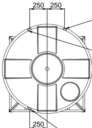
PE-Muffe mit durchgehendem Innengewinde  $\frac{1}{2}$ " H=200
