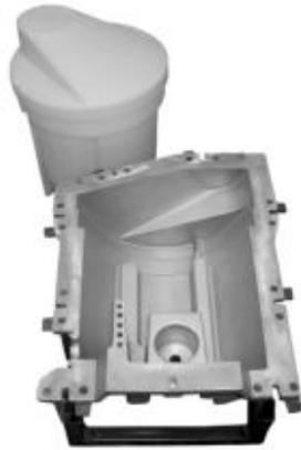
Das Rotationsschmelzverfahren erzeugt Hohlkörper aus Kunststoff. Es ist ein ideales Verfahren für Serien mit kleinen und mittleren Stückzahlen. Die Produkte sind druck- und stoßtolerant und komplett nahtlos. Polyethylen (PE), als das für den Prozess von uns meist verwendete Rohmaterial, ist resistent gegen die meisten Chemikalien, lebensmittelgeeignet und wiederverwertbar.
