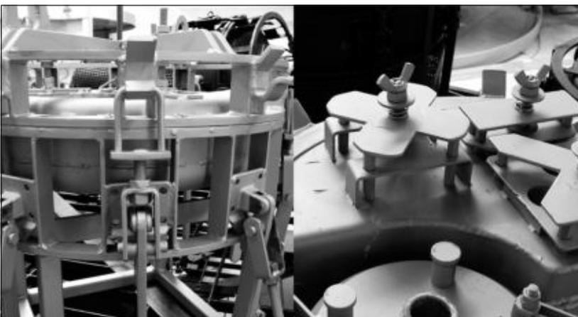
Die Produktionsformen/Werkzeuge für die Produkte sind zwei- oder mehrteilig, je nach Komplexität des Produktdesigns. Die Herstellung der Formen oder des Werkzeuges erfolgt durch einen spezialisierten Werkzeugbau. Als wirtschaftliche Lösung für individuelle Behälter-Serien bieten wir die Kombination von 1 Stück Produktionsform für das Behälter-Oberteil, mit mehreren exakt passenden Produktionsformen für das Behälter-Unterteil, z. B. in verschiedenen Höhen.
