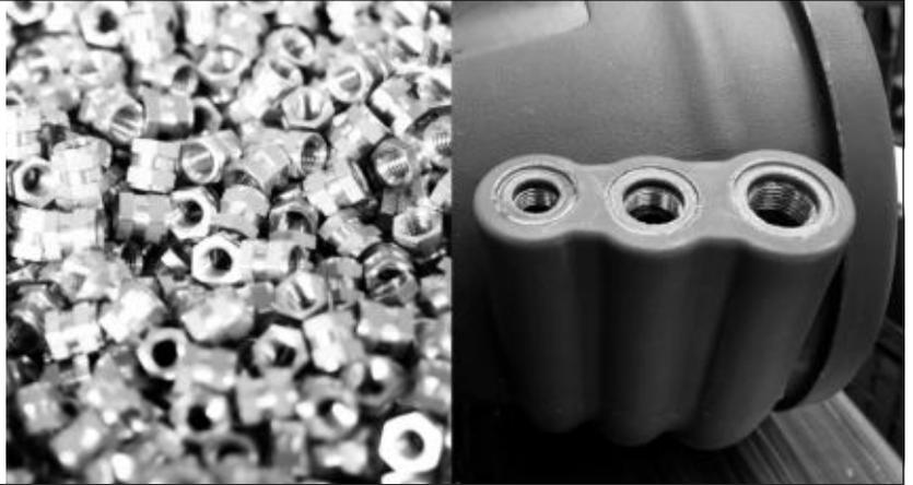
Der Produktionsprozess beinhaltet exakt bemessene Mengen an Rohstoff für jeden Produkttyp. Hierdurch wird die Wandstärke des Produktes festgelegt. Ein dynamisches Rotationschema erzielt darüber hinaus auch eine unterschiedliche Materialverteilung in der Form. Auf diese Weise können die Wandstärken an gewünschten Bereichen des Hohlkörpers gezielt erhöht oder gezielt verringert werden.
